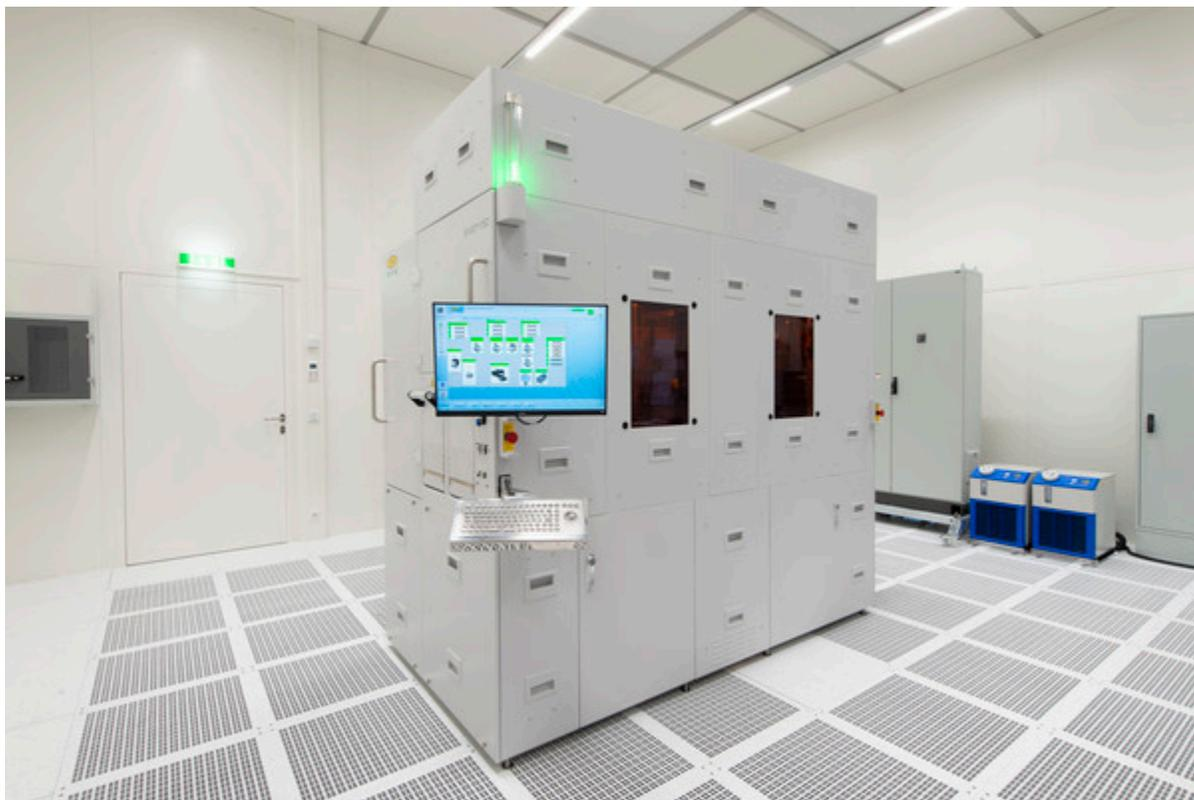
범용 플랫폼으로서 신뢰할 수 있는 고품질 코팅 및 현상 공정을 가능하게 하므로, 첨단 패키징, MEMS, RF, 3D 센싱, 전력 반도체, 포토닉스를 비롯한 다양한 디바이스 및 애플리케이션에 적용할 수 있다. 새로운 장비는 우수한 생산성과 유연성 및 반복성을 통해 대량 생산과 산업용 개발 양쪽 모두의 까다로운 요구를
