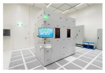
웨이퍼 본딩 및 리소그래피 장비 전문업체인 EV Group(이하 EVG)은 리소그래피 솔루션 포트폴리오에 속하는 차세대 200mm 제품으로 EVG®150 자동화 레지스트 처리 시스템을 출시한다고 8일 밝혔다. 새로운 디자인의 EVG150 플랫폼은 이전 세대 플랫폼과 비교해 최대 80%까지 높은 생산성과 우수한 범용성, 50% 더 작은 풋프린트가 특징이다. 범용 플랫폼으로서 신뢰할 수 있는 고품질 코팅 및 현상 공정을 지원해 첨단 패키징, MEMS, RF, 3D 센싱, 전력 반도체, 포토닉스를 비롯한 다양한 디바이스 및 애플리케이션에 적용할 수 있다. 새로운 장비는 우수한 생산성과 유연성 및 반복성을 통해 대량 생산과 산업용 개발 양쪽 모두의 까다로운 요구를 충족한다.
