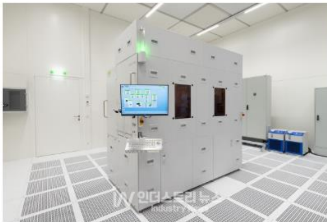
차세대 범용 플랫폼 'EVG150 레지스트 처리 시스템'은 최대 80% 향상된 생산성으로 고객을 지원한다. [사진=EVG]
