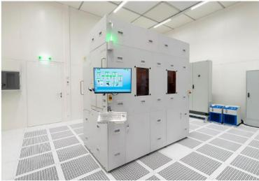
범용 플랫폼으로서 신뢰할 수 있는 고품질 코팅 및 현상 공정을 가능하게 하므로, 첨단 패키징, MEMS, RF, 3D 센싱, 전력 반도체, 포 토닉스를 비롯한 다양한 디바이스 및 애플리케이션에 적용할 수 있다. 새로운 장비는 우수한 생산성과 유연성 및 반복성을 통해 대량 생산과 산업용 개발 양쪽 모두의 까다로운 요구를 충족한다.
