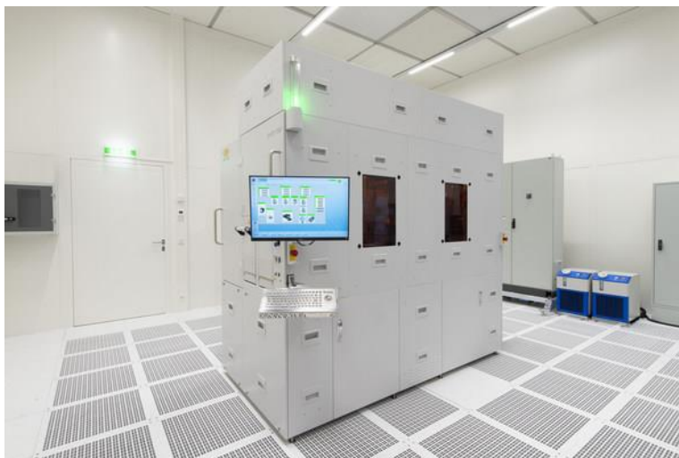
高い信頼性と高品質の塗布/現像プロセスを提供する全自動レジストプロセス装置EVG(r)150。最先端パ
