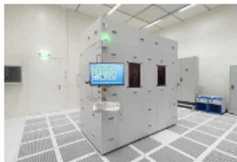
重新設計的200毫米版本EVG150光阻製程平台，提升產出產量以達到更高的製程產出，並且體積比傳統設備佔更少的佔地面積。
