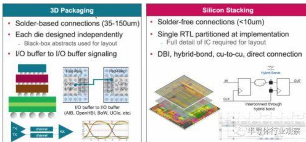
物理尺寸很重要。“对于最终的 3D 集成，你谈论的是 14 纳米间距，基本上就是今天的晶体管，”Uhrmann 说。“如果你谈论的是小芯片，它们是功能性 IP 块，那么你就在微米间距的范围内。晶体管堆叠和小芯片集成之间存在接近一个数量级。当您使用 3D 小芯片、高度集成的具有微米间距的裸片形成 3D 封装时，您无法将微米间距连接到外部世界。你仍然需要拥有封装技术才能使布线越来越粗，所以你最终会在板级上达到 400 多微米。”
