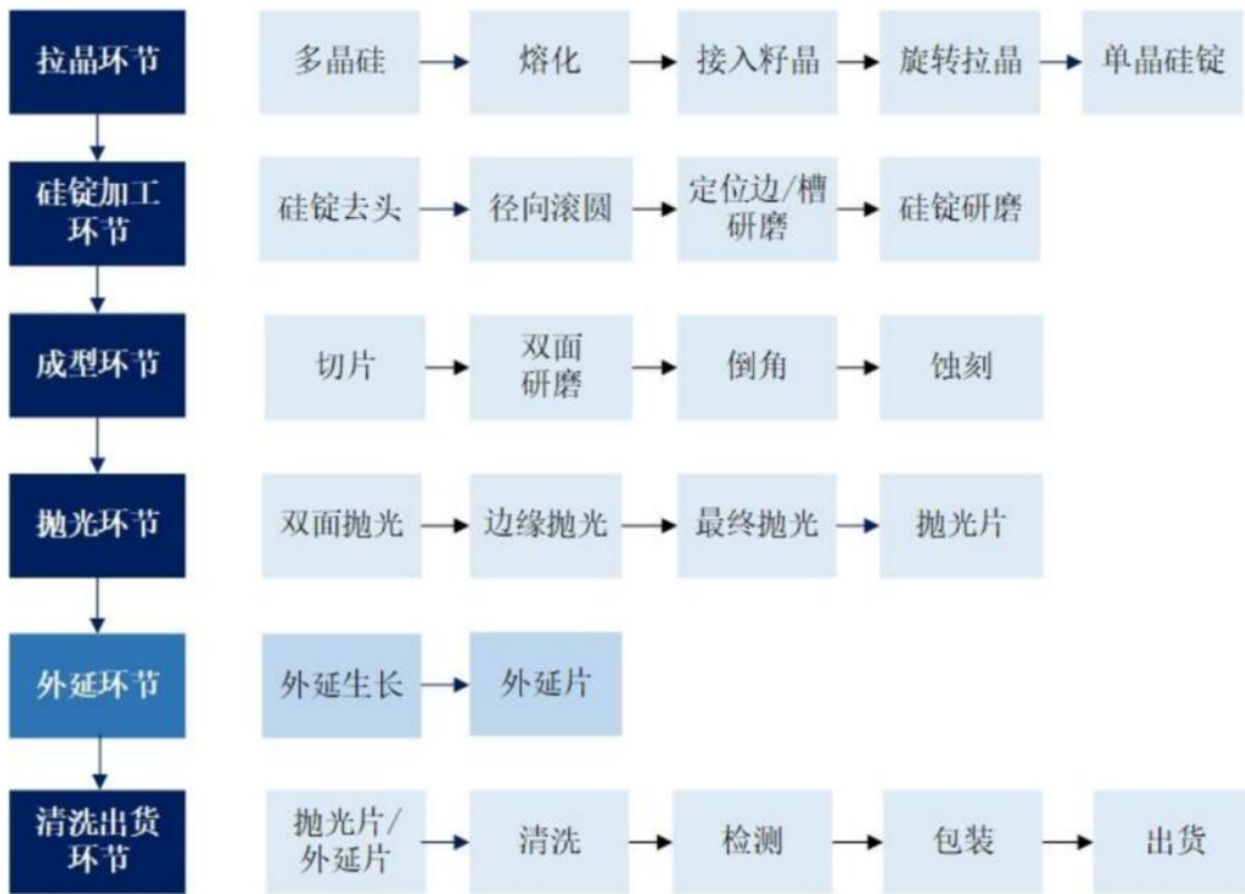
半导体抛光片、外延片工艺流程图 [6]
