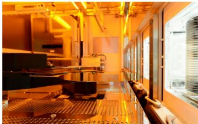
▲ EVG 850 NanoCleave 레이어 릴리즈 시스템은 나노미터 정밀도로 실리콘 기판으로부터 초박형 레이어를 분리할 수 있어 첨단 패키징 및 초전도체 스케일링을 위한 3D 집적에 혁신을 가져온다.
