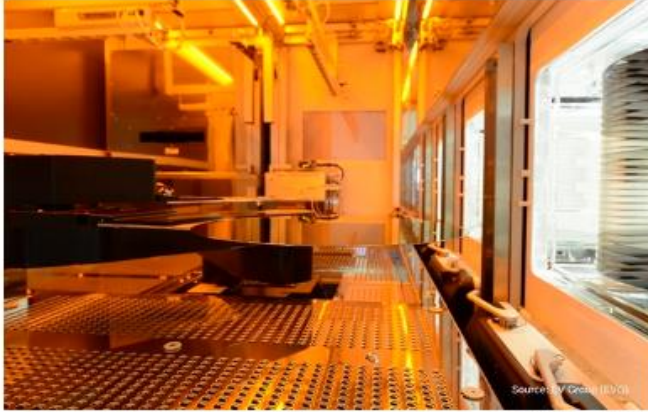
▲전처리 모듈 베이와 기계식 릴리즈 모듈을 배경으로 한 EVG®850 NanoCleave™ 레이어 릴리즈 시스템 내부 모습 / 사진=EV Group
