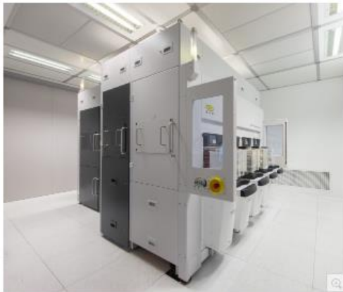
EVG R850 NanoCleave™ 레이어 릴리즈 시스템은 나노미터 정밀도로 실리콘 기판에서 초박형 레이어를 분리할 수 있어 첨단 패키징 및 트랜지스터 스케일링을 위한 3D 집적에 혁신을 가져온다.
