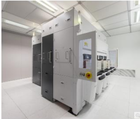
EVG 8850 NanoCleave™ 레이어 릴리즈 시스템은 나노미터 정밀도로 실리콘 기판에서 초박형 레이어를 분리할 수 있어 첨단 패키징 및 트랜지스터 스케일링을 위한 3D 집적에 혁신을 가져온다
