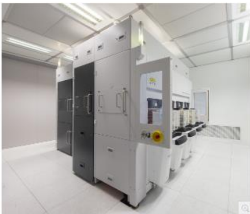
EVG850 NanoCleave™ 레이어 릴리즈 시스템은 나노미터 정밀도로 실리콘 기반에서 초박형 레이어를 분리할 수 있어 첨단 패키징 및 트랜지스터 스케일링을 위한 3D 집적에 혁신을 가져온다.
