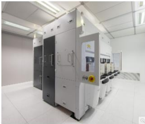
EVG의 NanoCleave™ 레이어 릴리즈 시스템은 나노미터 정밀도로 실리콘 기반에서 초박형 레이어를 분리할 수 있어 첨단 패키징 및 트랜지스터 스케일링을 위한 3D 집적에 혁신을 가져온다
