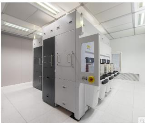
EVG WES0 NanoCleave™ 레이어 릴리즈 시스템은 나노미터 정밀도로 실리콘 기판에서 초박형 레이어를 분리할 수 있어 첨단 패키징 및 트랜지스터 스케일링을 위한 3D 집적에 혁신을 가져온다
