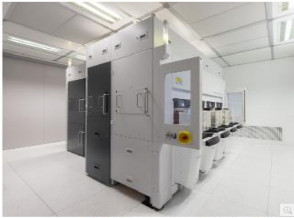
EVG#850 NanoCleave™ 레이어 릴리즈 시스템은 나노미터 정밀도로 실리콘 기판에서 초박형 레이어를 분리할 수 있어 첨단 패키징 및 트랜지스터 스케일링을 위한 3D 집적에 혁신을 가져옵니다.
