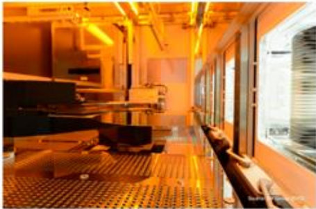
클리어 모듈 웨이퍼 기계가 실리콘 웨퍼를 세련으로 한 EVG8500 NanoCleave® 웨이퍼 클리어 시스템 내부 모습. (출처: EV Group)
