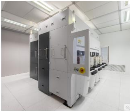
EVG850 NanoCleave™ 레이어 릴리즈 시스템은 나노미터 정밀도로 실리콘 기판에서 초박형 레이어를 분리할 수 있어 첨단 패키징 및 트랜지스터 스케일링을 위한 3D 집적에 혁신을 가져온다.
