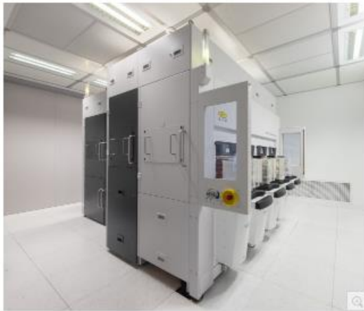
EVG의 NanoCleave™ 레이어 릴리즈 시스템은 나노미터 정밀도로 실리콘 기판에서 초박형 레이어를 분리할 수 있어 첨단 패키징 및 트랜지스터 스케일링을 위한 3D 집적에 혁신을 가져온다.
