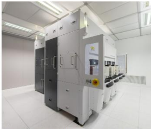
<EVG 850 나노클리브™ 레이저 릴리즈 시스템은 나노미터 정밀도로 실리콘 기판으로부터 초박형 웨이퍼를 분리할 수 있어 첨단 패키징 및 트랜지스터 스케일링을 위한 3D 집적에 도움이 있다.>
