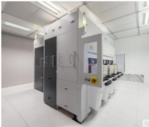
EVG NB50 NanoCleave™ 레이어 릴리즈 시스템은 나노미터 정밀도로 실리콘 기판에서 초박형 레이어를 분리할 수 있어 첨단 패키징 및 트랜지스터 스케일링을 위한 3D 집적에 혁신을 가져옵니다
