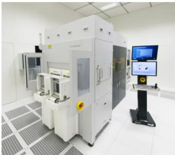
EVG의 혁신적인 LITHOSCALE 마스크리스 노광 시스템은 높은 수준의 유연성이나 제품 다양성이 필요한 시장 및 애플리케이션의 리소그래피 요구를 충족한다. (사진: EVG)
