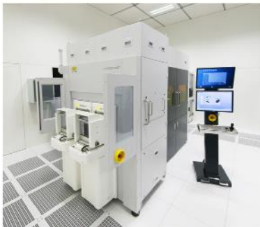
EVG의 LITHOSCALE 시스템은 피엠티 본사(중남 아산시 소재)에 설치돼 첨단 NAND, DRAM, 고대역폭 메모리(HBM) 디바이스의 웨이퍼 레벨 테스트용 저세대 MEMS 기반 프로브 카드 제조에 사용될 예정이다. (사진=EVG)
