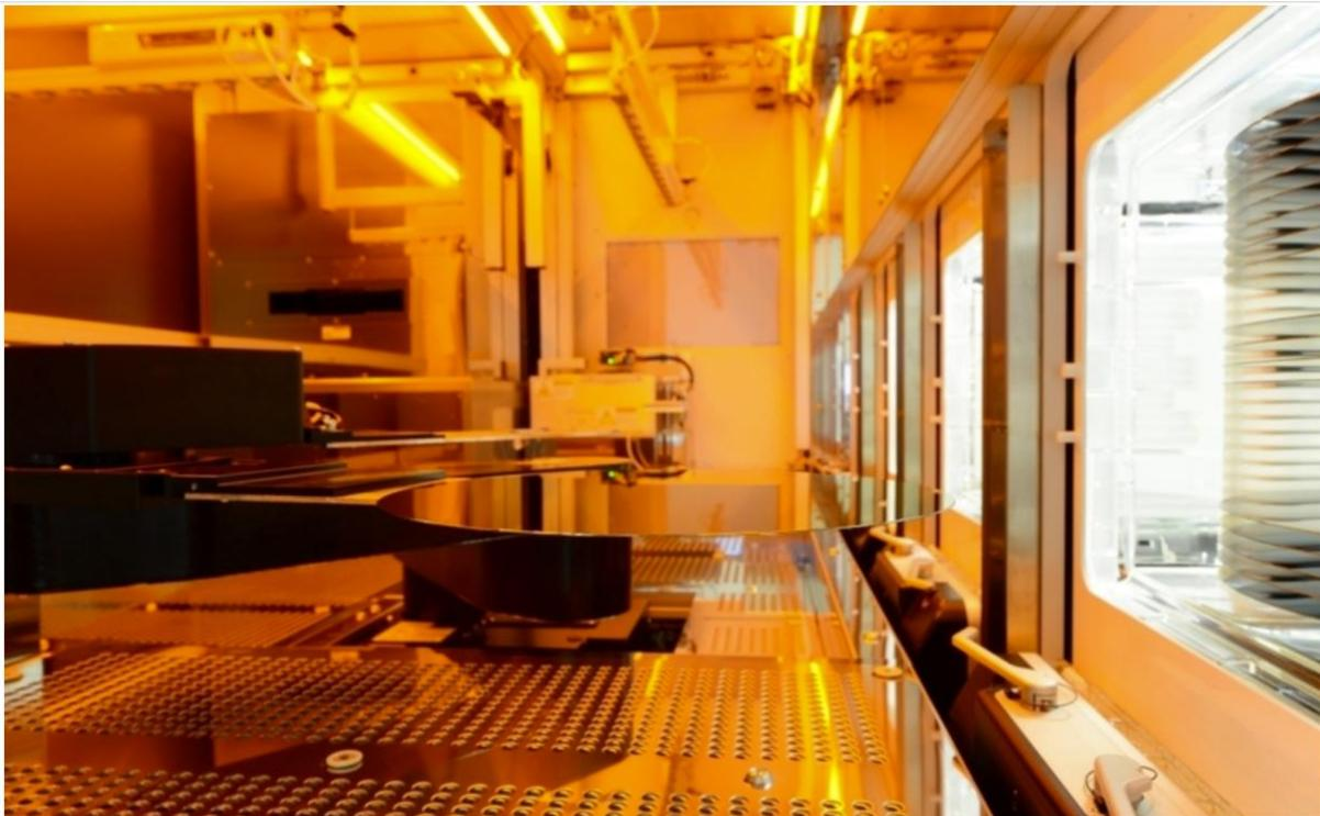
▲ EVG 850 NanoCleave 레이어 릴리즈 시스템은 나노미터 정밀도로 실리콘 기판으로부터 초박형 레이어를 분리할 수 있어 첨단 패키징 및 트랜지스터 스케일링을 위한 3D 집적에 혁신을 가져온다.
