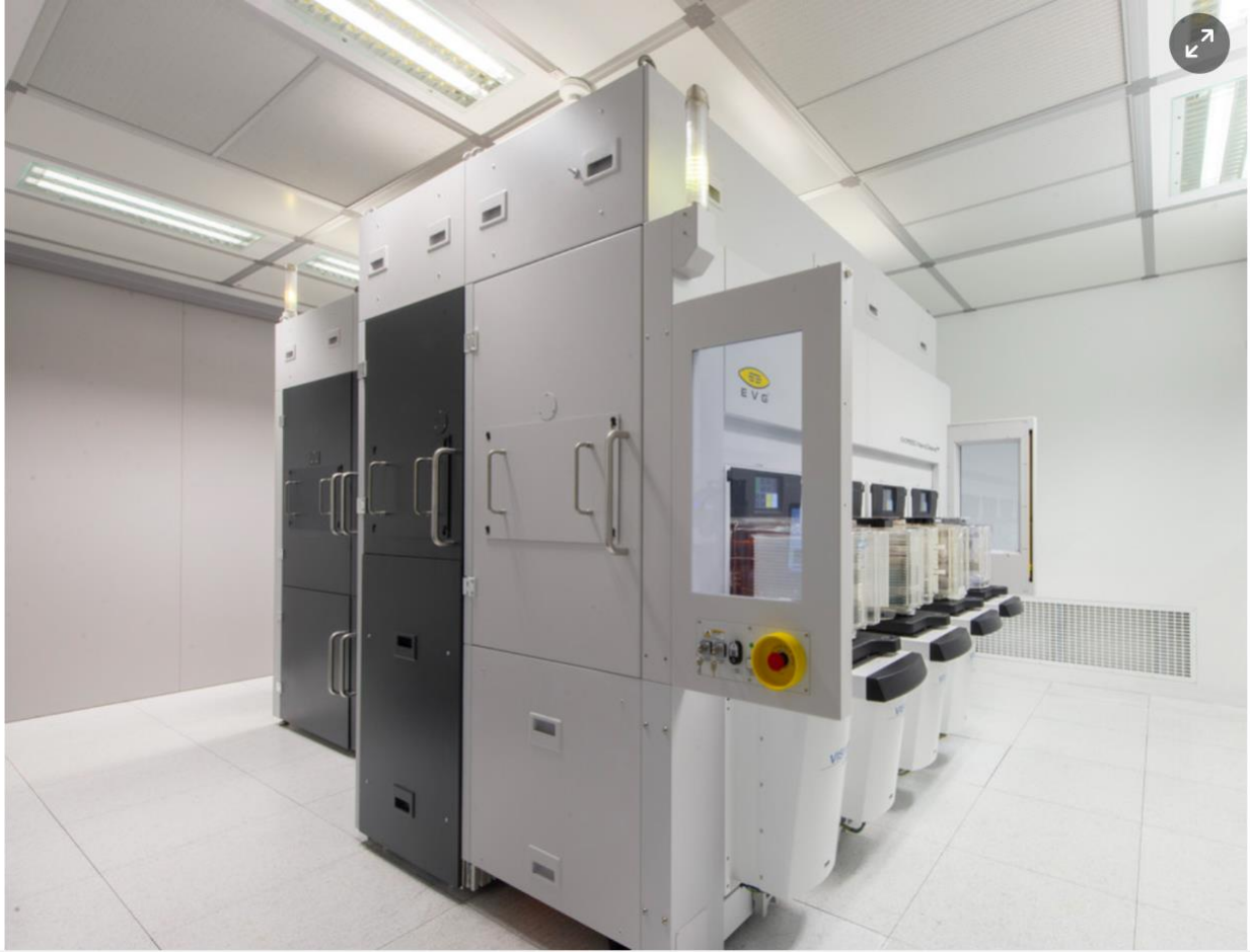
EVG®850 NanoCleave 레이어 릴리즈 시스템은 나노미터 정밀도로 실리콘 기판으로부터 초박형 레이어를 분리할 수 있어 첨단 패키징과 트랜지스터 스케일링을 위한 3D 집적에 혁신을 가져온다. 사진=EV Group(EVG)
