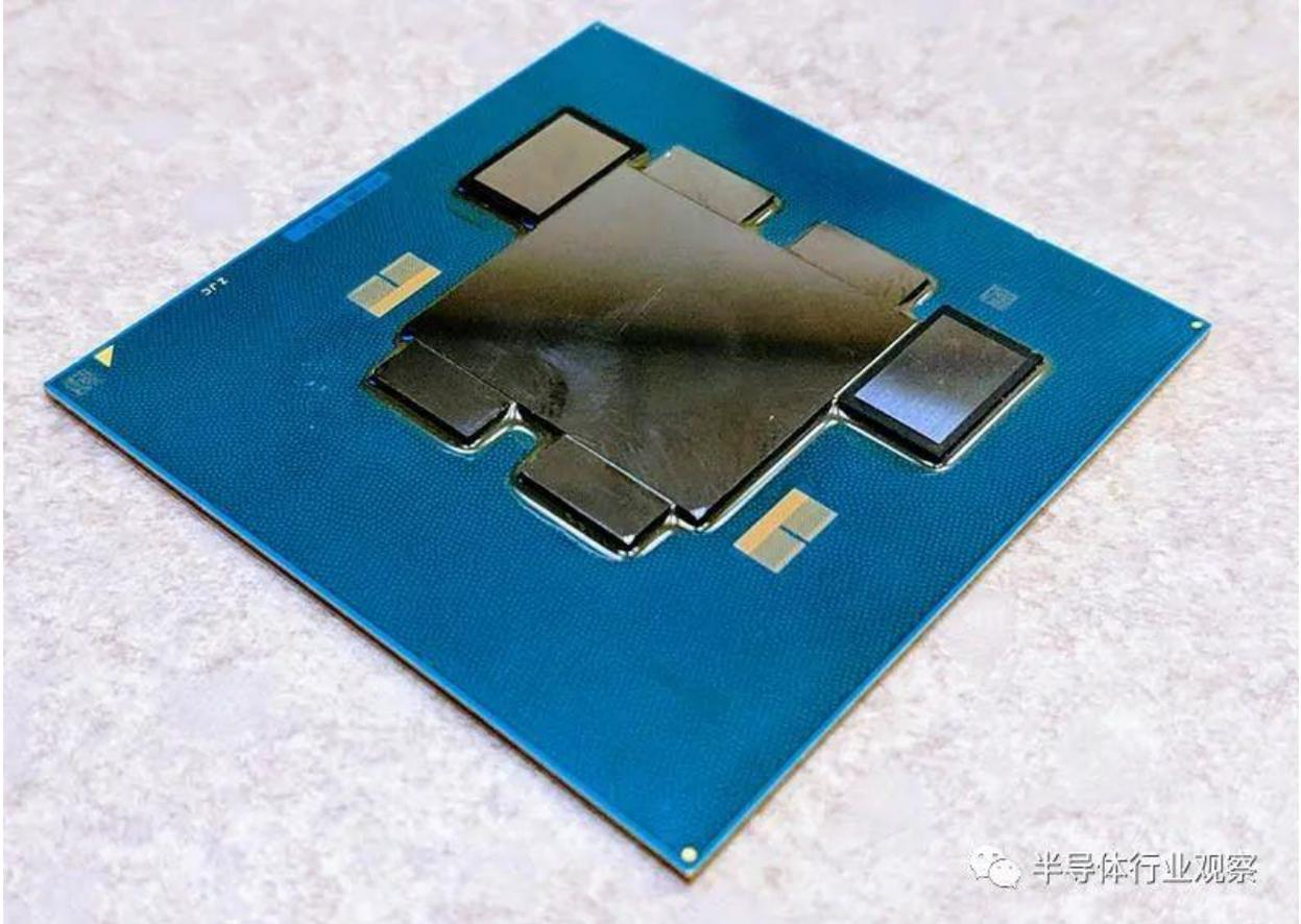
英特尔可以通过这个芯片将功率推送到上面的有源芯片。如果需要，英特尔还可以灵活地设计封装以在没有 EMIB 和某些小芯片的情况下运行。在英特尔 FPGA 的一些拆解发现，如果英特尔发货的 SKU 不需要它，英特尔将不会放置 EMIB 和有源芯片。这允许围绕某些细分市场的物料清单进行一些优化。
