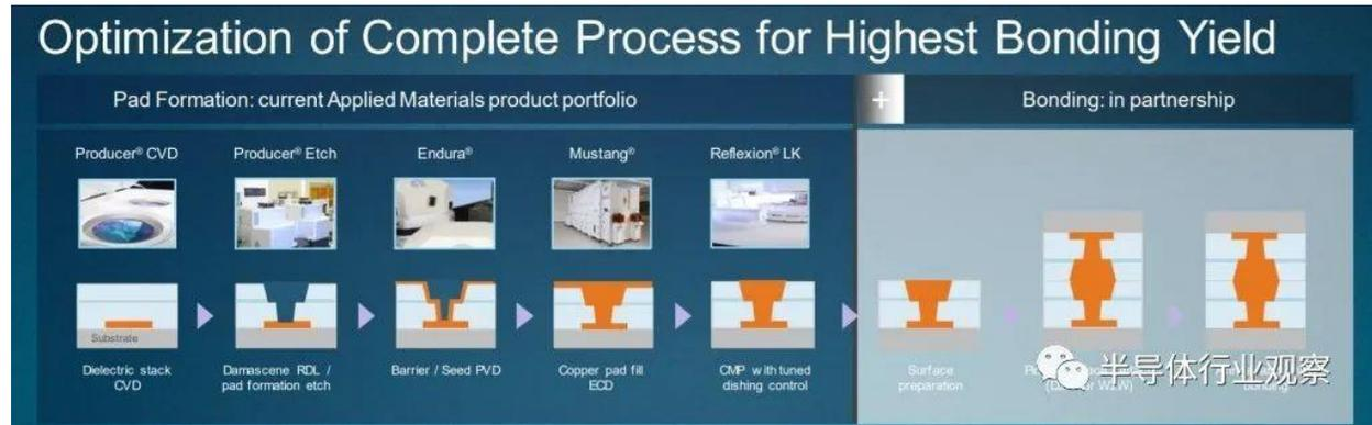
混合键合是一种技术，它不使用凸点，而是将芯片直接与硅通孔连接。如果我们回到倒装芯片工艺，没有凸块形成、助焊剂、回流或模下填充芯片之间的区域。铜直接遇到铜。实际过程非常困难，上面部分详述。在本系列的下一部分中，我们将深入研究工具生态系统和混合绑定类型。与之前描述的任何其他封装方法相比，混合键合能够实现更密集集成。
