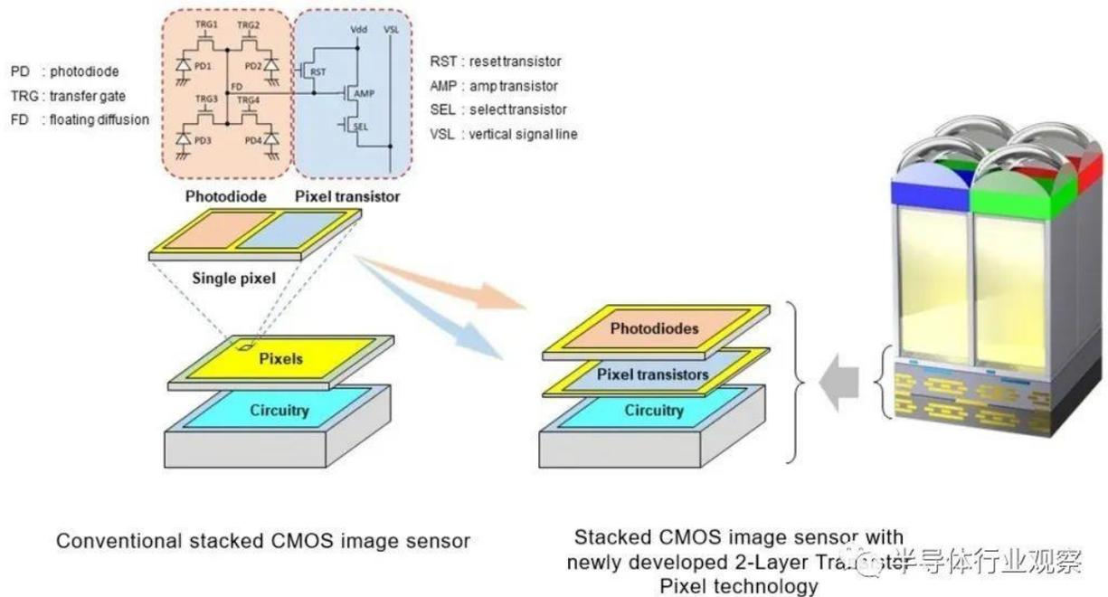
目前索尼提供 2 stack 和 3 stack 版本。在 2 堆栈中，像素位于电路的顶部。在 3 堆栈版本中，像素堆叠在电路顶部的 DRAM 缓冲区缓存的顶部。随着索尼希望将像素晶体管从电路中分离出来并创建具有多达 4 层硅的更先进的相机，进步仍在继续。由于其 CMOS 图像传感器业务，三星是混合键合芯片的第二大出货量出货商。
