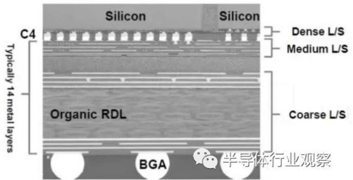
标准封装将具有核心基板，每侧有 2 到 5 层重分布层 (RDL)，包括更高级的集成扇出。台积电的 InFO-SoI (集成基板系统) 将这一概念提升到一个新的水平。它提供多达 14 个重新分布层 (RDL)，可在芯片之间实现非常复杂的布线。在靠近管芯的基板上还有一层更高密度的布线层。
