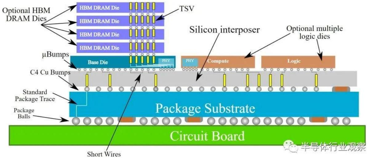
最大的亮点是 CoWoS-S（硅中介层）。它涉及采用已知良好的芯片，倒装芯片将其封装到无源晶圆上，该晶圆上具有图案化的导线。这就是 CoWoS 名称的来源，Chip on Wafer on Substrate。从长远来看，它是体积最大的 2.5D 封装平台。如第 1 部分所述，这是因为 P100、V100 和 A100 等 Nvidia 数据中心 GPU 使用 CoWoS-S。虽然 Nvidia 的销量最高，但 Broadcom、Google TPU、Amazon Trainium、NEC Aurora、Fujitsu A64FX、AMD Vega、Xilinx FPGA、Intel Spring Crest 和 Habana Labs Gaudi 只是 CoWoS 使用的几个值得注意的例子。大多数使用 HBM 计算的重型芯片，包括来自各种初创公司的 AI 训练芯片都使用 CoWoS。
