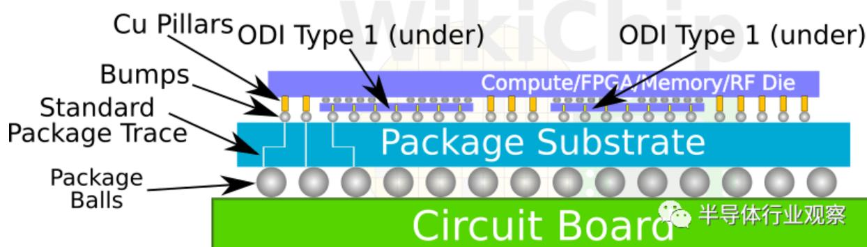
Foveros Omni 从未像 EMIB 那样嵌入基板内部，它在任何情况下都完全位于基板之上。堆叠类型会导致封装基板与位于其上的芯片的连接高度不同的问题。英特尔开发了一种铜柱技术，让他们可以将信号和电源传输到不同的 z 高度并通过芯片，这样芯片设计人员在设计 3D 异构芯片时可以有更多的自由。Foveros Omni 将从 36 微米的凸点间距开始，但在下一代将降低到 25 微米。
