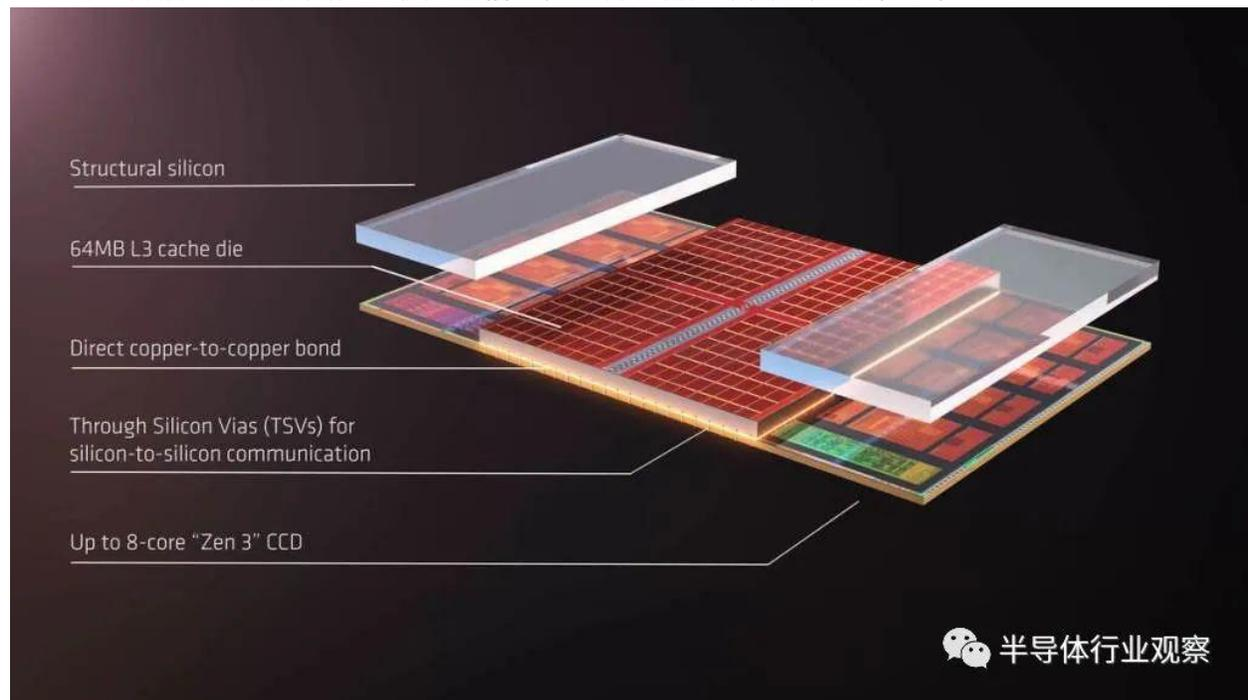
最著名的混合键合芯片当然是最近宣布的 AMD 的 3D 堆叠缓存，它将于今年早些时候发布。这利用了台积电的 SoIC 技术。英特尔的混合键合品牌称为 Foveros Direct，三星的版本称为 X-Cube。Global Foundries 公开了使用混合键合技术的 Arm 测试芯片。产量最高的混合键合半导体公司不是台积电，今年甚至明年也不会是台积电。出货最多的混合键合芯片的公司实际上
