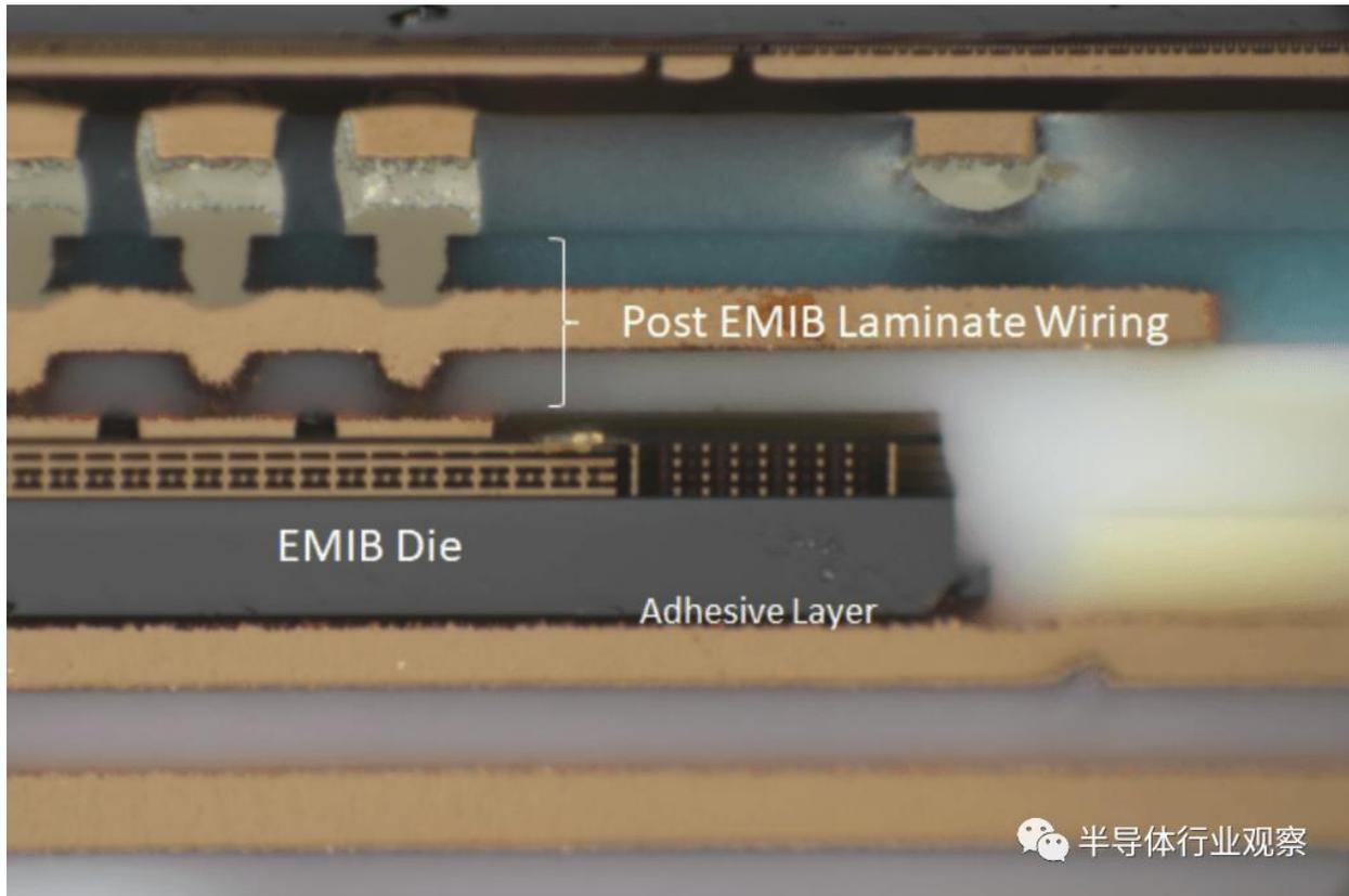
通过继续使用现有的有机层压板和 ABF 供应链，英特尔放弃了更昂贵的硅基板材料和硅制造工艺。总的来说，这条供应链是商品化的，尽管目前由于短缺而相当紧张。自 2018 年以来，英特尔的 EMIB 一直在产品中发货，包括 Kaby Lake G、各种 FPGA、Xe HP GPU 和某些云服务器 CPU，包括 Sapphire Rapids。目前所有 EMIB 产品都使用 55 微米，但第二代是 45 微米，第三代是 40 微米。
