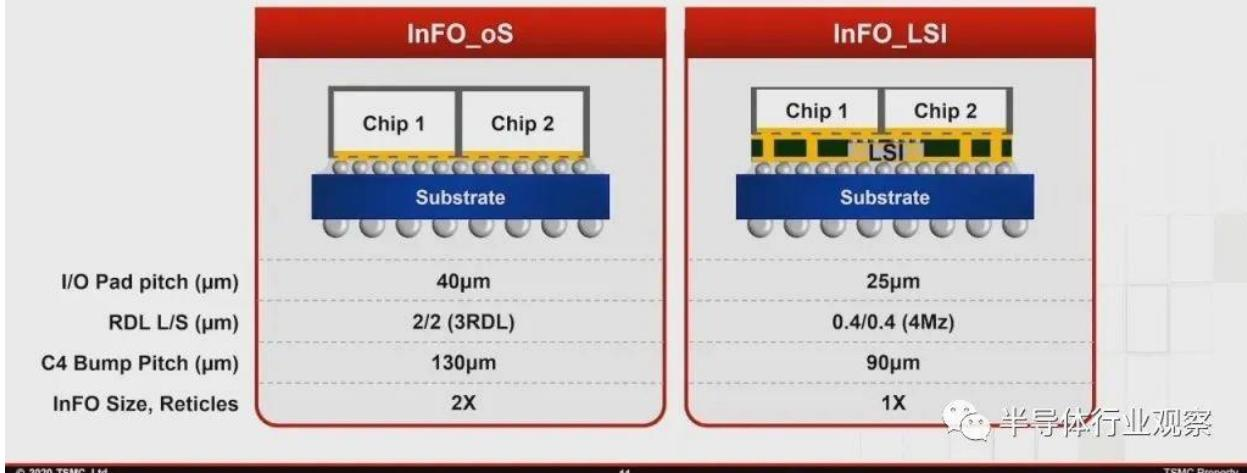
最后，在台积电的集成扇出阵容中，还有 InFO-LSI（本地硅互连）。InFO-LSI 是 InFO-R，但在多个芯片下方有一块硅。这种局部硅互连将开始作为多个 die 之间的无源互连，但未来可以演变为有源（晶体管和各种 IP）。它最终也将缩小到 25 微米，但我们认为第一代不会出现这种情况。第一款采用这种类型封装的产品将在后面展示。
