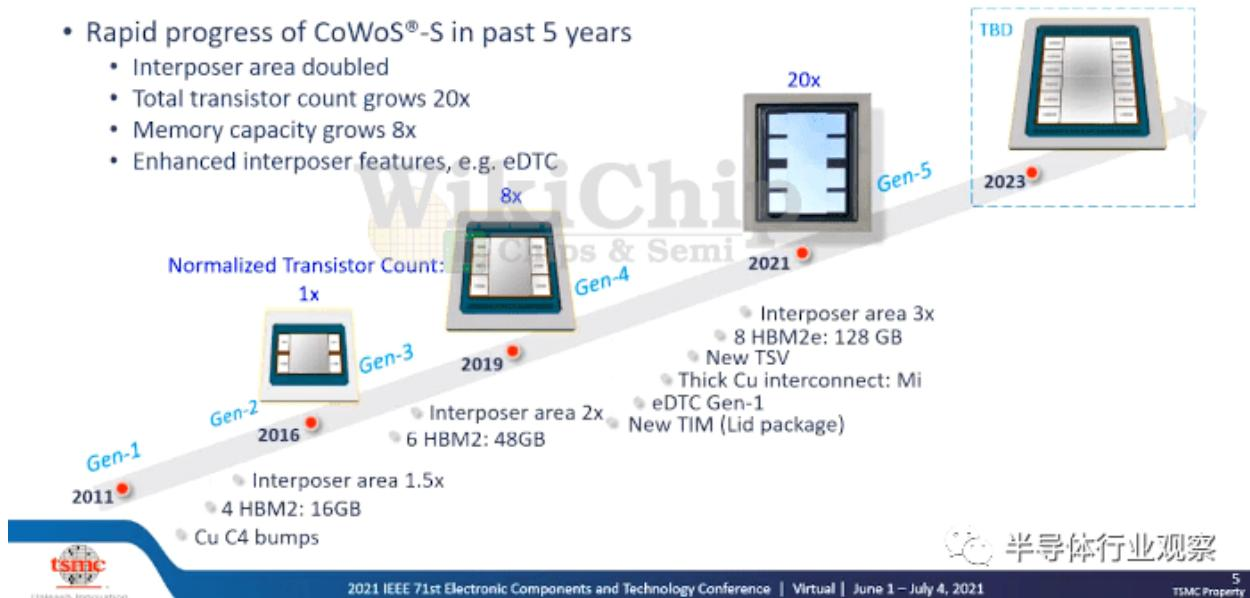
回到技术上，CoWoS-S 多年来经历了一次演变。主要特点是中介层面积越来越大。由于 CoWoS 平台使用硅制造技术，因此它遵守称为光罩限制的原则。使用 193nm ArF 光刻工具可以印刷的最大尺寸为 33mm x 26mm (858mm<sup>2</sup>)。硅中介层的主要用途也是光刻定义的，即连接位于其上的芯片的非常密集的电线。英伟达的芯片早已接近标线限制，但仍需要连接到封装的高带宽内存。
