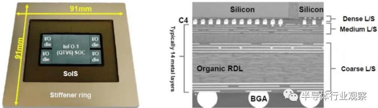
标准封装将具有核心基板，每侧有 2 到 5 层重分布层 (RDL)，包括更高级的集成扇出。台积电的 InFO-SoIS (集成基板系统) 将这一概念提升到一个新的水平。它提供多达 14 个重新分布层 (RDL)，可在芯片之间实现非常复杂的布线。在靠近管芯的基板上还有一层更高密度的布线层。
