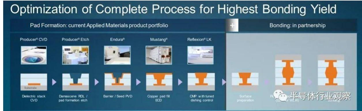
混合键合是一种技术，它不使用凸点，而是将芯片直接与硅通孔连接。如果我们回到倒装芯片工艺，没有凸块形成、助焊剂、回流或模下填充芯片之间的区域。铜直接遇到铜。实际过程非常困难，上面部分详述。在本系列的下一部分中，我们将深入研究工具生态系统和混合绑定类型。与之前描述的任何其他封装方法相比，混合键合能够实现更密集的集成。
