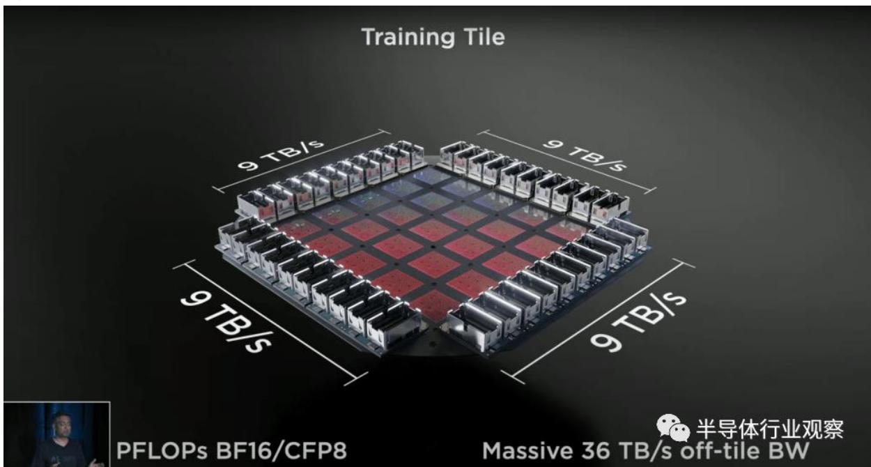
TSMC 还提供 InFO-SOW (晶圆上系统)，它允许扇出包含数十个芯片的整个晶圆的大小。我们撰写了有关使用这种特殊包装形式的 Tesla Dojo 1 的文章。我们还在特斯拉去年的 AI 日公布这项技术的几周前独家披露了该技术的使用情况。特斯拉将在 HW 4.0 中使用三星 FOSiP。
