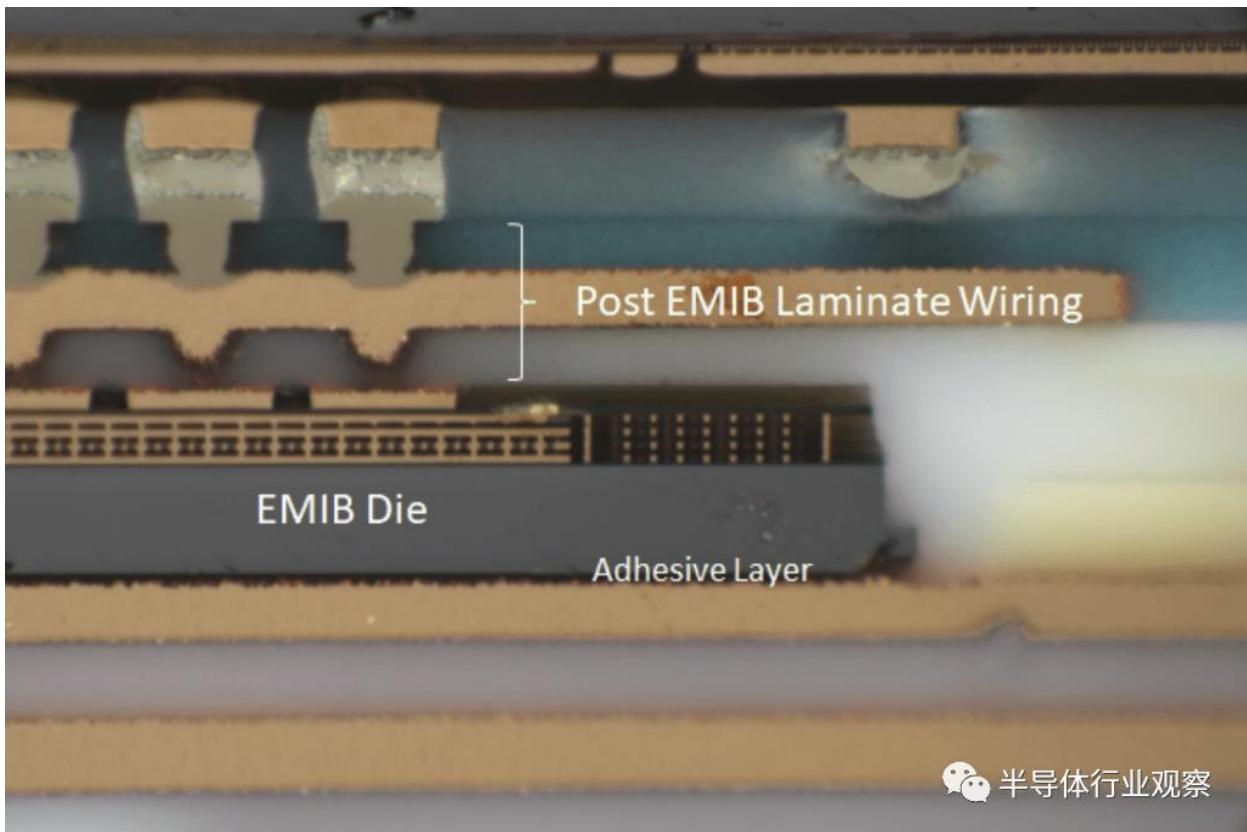
通过继续使用现有的有机层压板和 ABF 供应链，英特尔放弃了更昂贵的硅基板材料和硅制造工艺。总的来说，这条供应链是商品化的，尽管目前由于短缺而相当紧张。自 2018 年以来，英特尔的 EMIB 一直在产品中发货，包括 Kaby Lake G、各种 FPGA、Xe HP GPU 和某些云服务器 CPU，包括 Sapphire Rapids。目前所有 EMIB 产品都使用 55 微米，但第二代是 45 微米，第三代是
