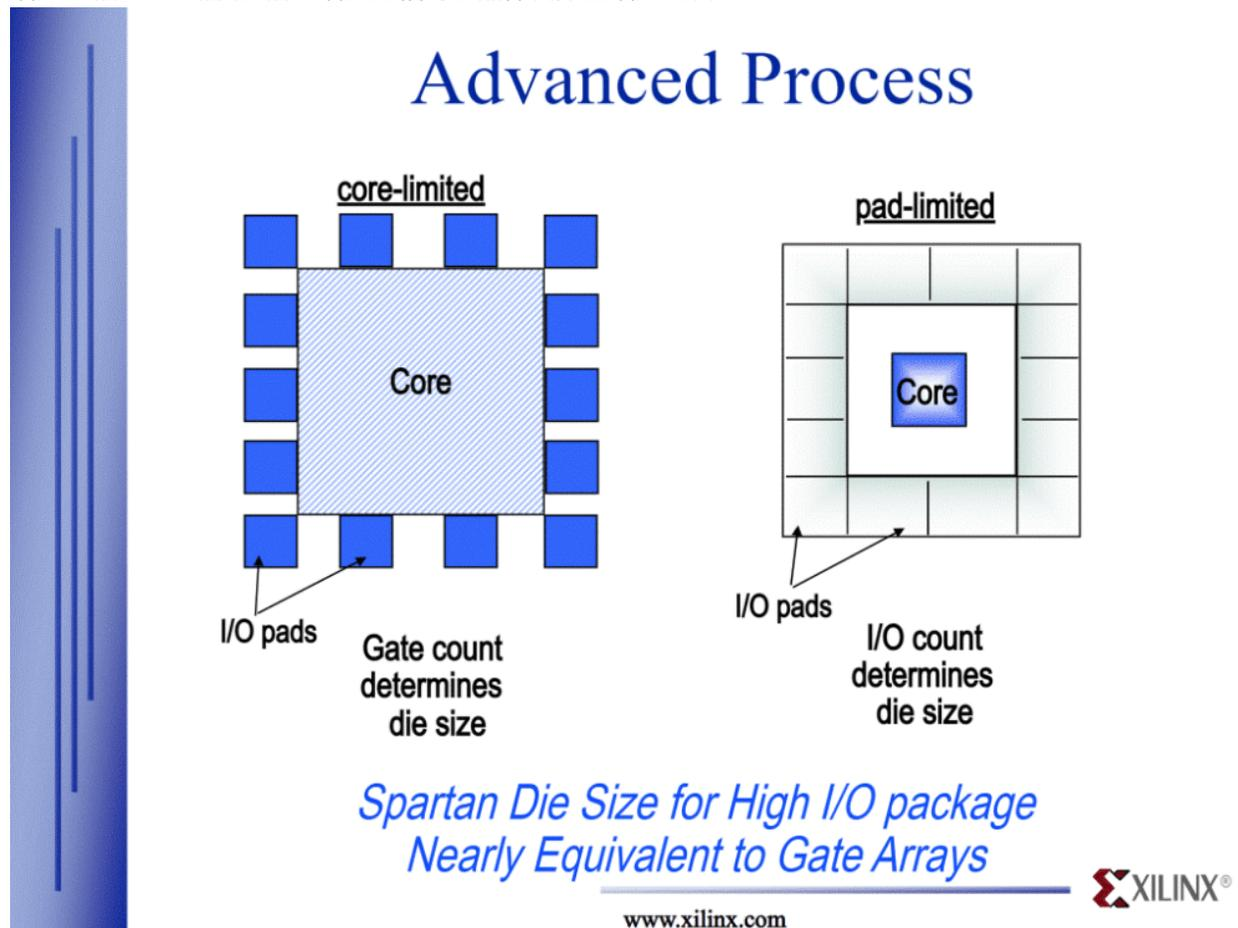
这带来了 pad (硅片的管脚) 受限设计的概念。将旧设计转移到新工艺节点时，设计本身可能会大幅缩小，但 IO 需求会阻止芯片尺寸缩小多少。由于需要 IO，裸片尺寸保持较大且留有空白空间。这些情况称为 pad limited，并且非常频繁。
