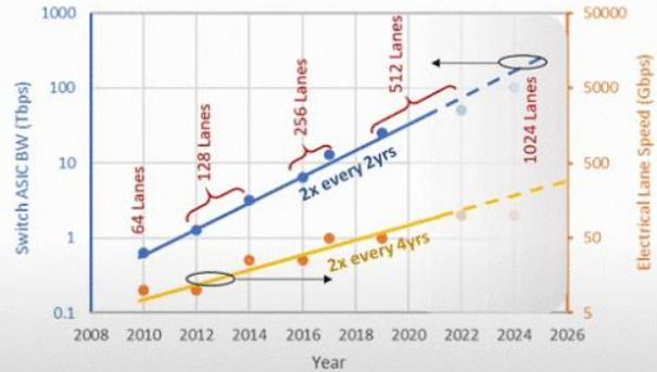
芯片上数据的输入和输出 (IO) 是计算的命脉。将内存置于芯片上有助于通过减少通信开销来减少 IO 需求，但归根结底，这是一种有限的扩展途径。处理器必须与外部世界进行交易以发送和接收数据。摩尔定律使业界的晶体管密度大约每 2 年增加 2 倍，但 IO 数据的速率每 4 年才增加 2 倍。几十年来，晶体管密度与 IO 数据速率的这种差异出现了巨大差异。共同封装的光学器件只是解决这个问题的一种方法，它并不是单独出现的。
