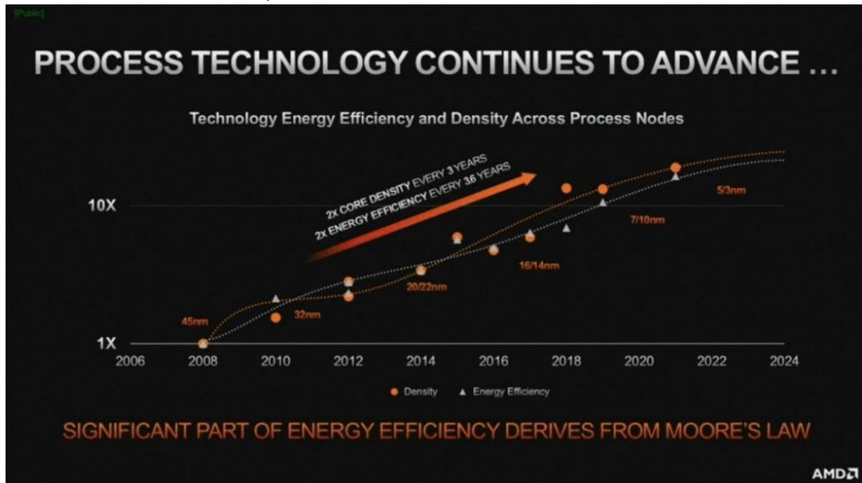
首先让我们讨论一下对先进封装的需求。摩尔定律以迅猛的速度发展。自台积电 32nm 失误以来，直到目前的 5nm 工艺节点，台积电的晶体管密度每年增长 2 倍。尽管如此，真实芯片的密度每 3 年增长约 2 倍。这种较慢的速度部分是由于 SRAM 缩放、功率传输和热密度的消亡，但大多数这些问题都与数据的输入和输出有关。
