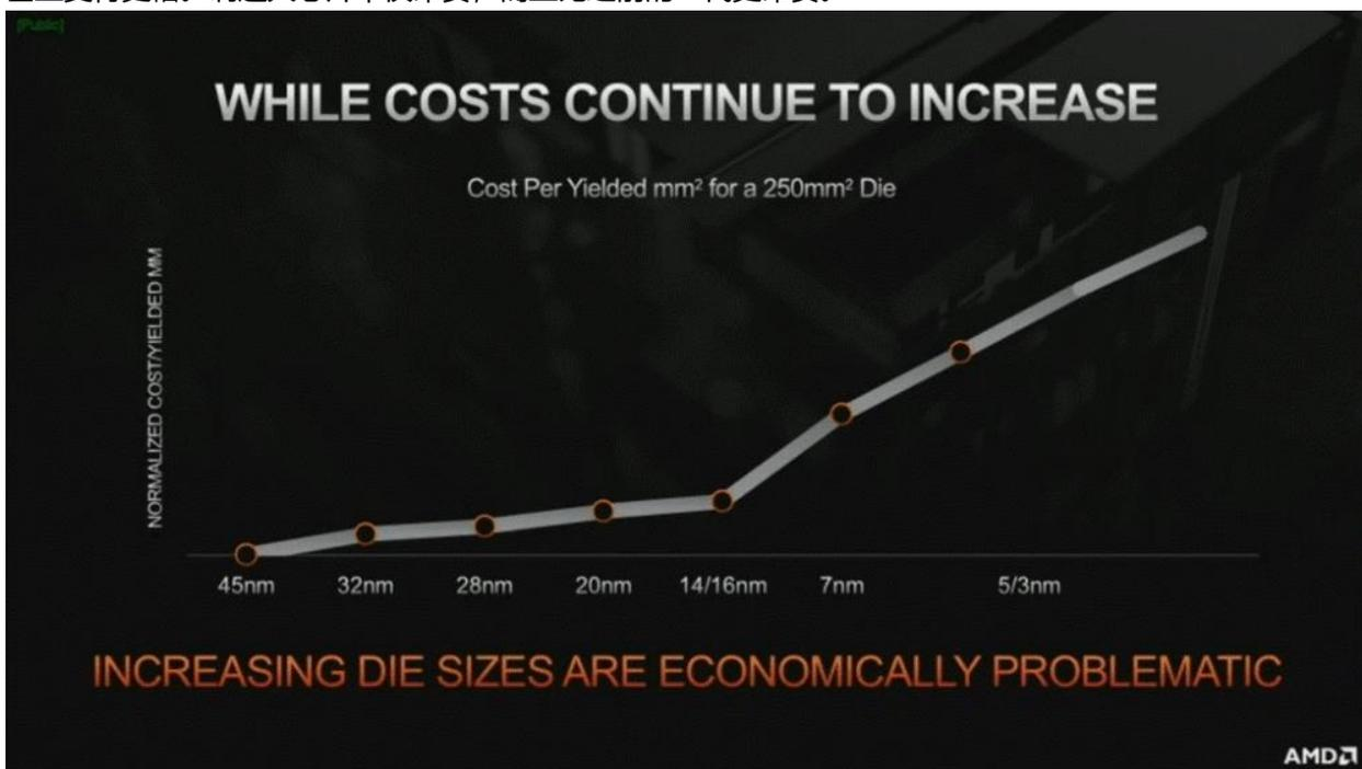
这张来自 AMD 的图表描绘了一幅非常病态的画面。虽然每个节点的转变并不相同，但很明显，在 7nm 和 5nm 处，该行业已经达到了拐点。每产出平方毫米的成本增加幅度不是很小，而是很大。尽管节点转换带来了类似的密度增益，或者可能由于 SRAM 缩放速度放缓而更糟，但成本的增加并没有跟上。与每晶体管成本相关的趋势逆转令业界震惊。这种逆转具有巨大的影响，甚至导致无知的银行家以此为理由，下调台积电的评级，称其估值过高。
