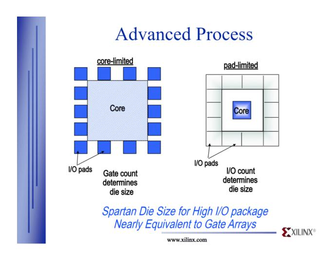
这带来了pad(硅片的管脚)受限设计的概念。将旧设计转移到新工艺节点时,设计本身可能会大幅缩小,但 IO 需求会阻止芯片尺寸缩小多少。由于需要 IO,裸片尺寸保持较大且留有空白空间。这些情况称为pad limited,并且非常频繁。
