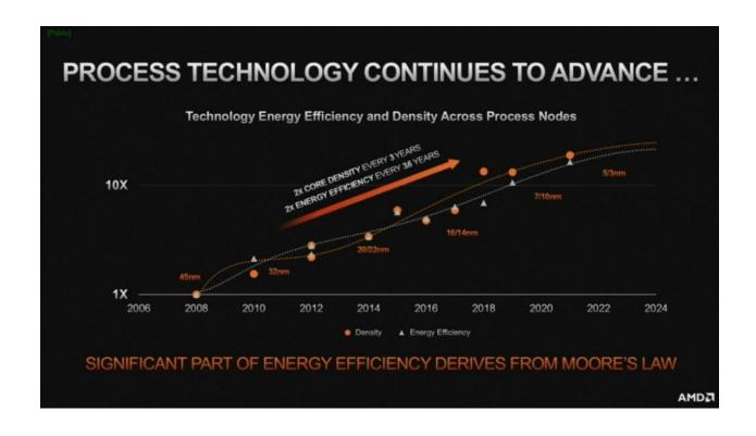
首先让我们讨论一下对先进封装的需求。摩尔定律以迅猛的速度发展。自台积电 32nm 失误以来,直到目前的 5nm 工艺节点,台积电的晶体管密度每年增长 2 倍。尽管如此,真实芯片的密度每 3 年增长约 2 倍。这种较慢的速度部分是由于 SRAM 缩放、功率传输和热密度的消亡,但大多数这些问题都与数据的输入和输出有关。
