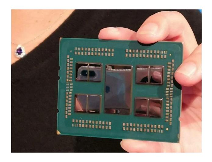
随着我们继续收缩,预期收益率会缓慢下降。这是一个合乎逻辑的结论,因为每个连续的节点都会增加约35%的流程步骤。当前沿流程在数千个流程步骤中进行衡量时,错误开始迅速堆积。工业公司喜欢谈论 "Six Sigma",但这对半导体制造来说还不够。让我们假设一个有2000个工艺步骤的过程,每个步骤的每 cm?缺陷数为Six Sigma。那么D0(每 cm?缺陷率的行业术语)最终将是0.678。芯片越大,出现缺陷的可能性就越大。
