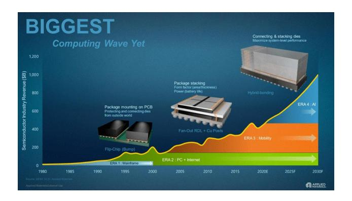
传统的倒装芯片封装的凸点间距在 150 微米到 200 微米之间。这意味着每个 IO 单元在裸片的底侧相距 150 到 200 微米。台积电 N7将凸点间距降低到 130 微米,英特尔的 10nm 将凸点间距降低到 100 微米,这些进步被称为细间距倒装芯片。不要小看这些进步,因为它们极大地促进了更好的处理器,但 2000 年的 封装技术与 2021 年的封装技术基本相同。
