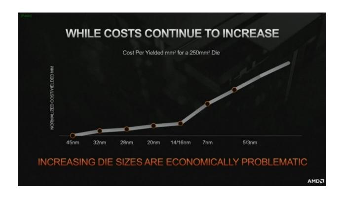
这张来自 AMD 的图表描绘了一幅非常病态的画面。虽然每个节点的转变并不相同,但很明显,在 7nm 和 5nm 处,该行业已经达到了拐点。每产出平方毫米的成本增加幅度不是很小,而是很大。尽管节点转换带来了类似的密度增益,或者可能由于 SRAM 缩放速度放缓而更糟,但成本的增加并没有跟上。与每晶体管
