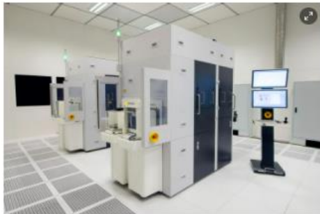
EVG7300 SmartNIL, 나노임프린트 및 웨이퍼레벨 광학 시스템 (source:evg)
