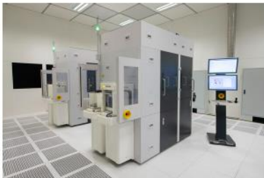
EVG 7300 SmartNIL 나노임프린트 및 웨이퍼 레벨 광학 시스템은 여러 UV 기반 광학 기능을 단일 플랫폼에 결합한 다기능 솔루션이다. (제공=EVG코리아)
