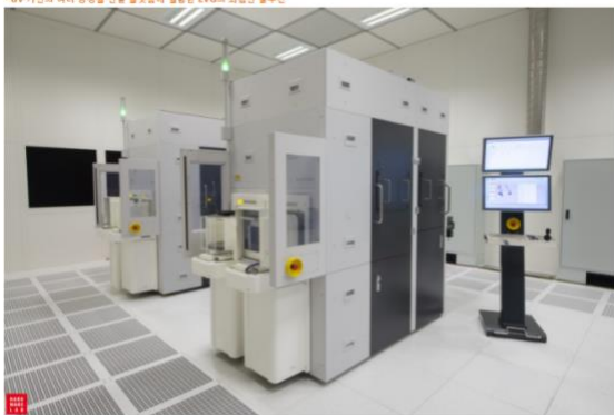
EV 그룹(EVG)은 자동화된 SmartNIL 나노임프린트 및 마이크로 및 나노 광학 시스템인 EVG 7300을 출시한다고 밝혔다. EVG의 최신 솔루션인 EVG7300은 나노임프린트 리소그래피(NIL), 렌즈 몰딩 및 렌즈 스택킹(UV 분할) 같은 UV 기반의 여러 프로세스를 단일 플랫폼에 결합한 것이 특징이다. 이 시스템을 다기능 시스템은 마이크로 및 나노 리소그래피용 솔루션이 제공하는 광범위한 신규 어플리케이션의 첨단 R&D와 생산 공정에 사용될 수 있다.
