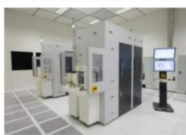
EVG®7300自动化SmartNIL®纳米压印与晶圆级光学系统在单个平台上结合了多种紫外光刻技术，是一套先进的多性能解决方案。
