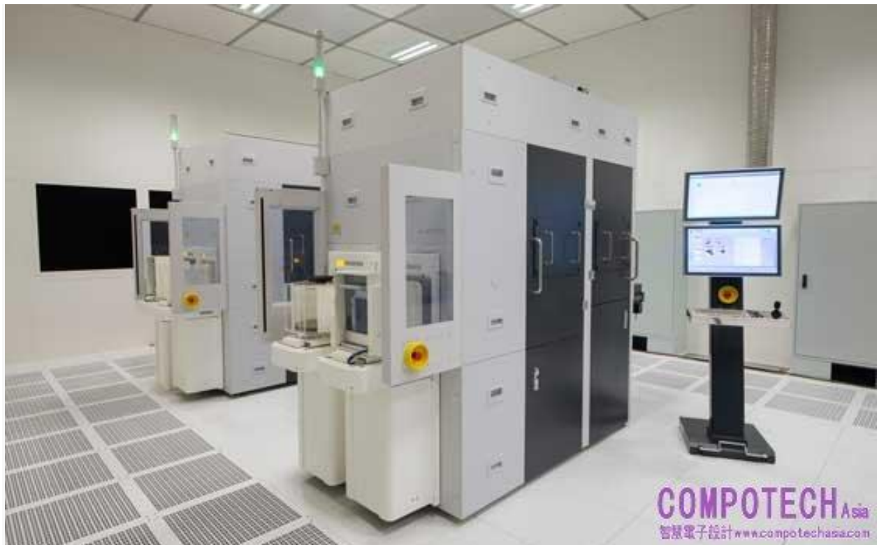
圖一_EVG®7300 SmartNIL®奈米壓印與晶圓級光學系統是具備多功能且先進的解決方案，可在單一平台上結合多重基於UV架構的製程。
