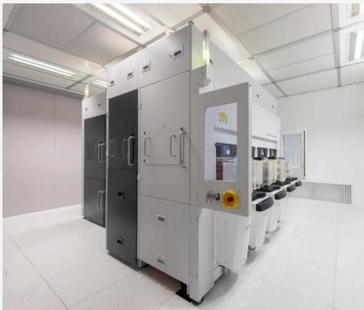
台北，2023年12月12日 —微機電系統（MEMS）、奈米科技與半導體市場的晶圓接合暨微影技術設備之領導廠商 EV Group (EVG)，宣布推出 EVG®850 NanoCleave™ 薄膜剝離系統，這是首度採用 EVG 革命性 NanoCleave 技術的產品平台。EVG850 NanoCleave 系統使用紅外線（IR）雷射搭配特殊的無機物材質，在透過實際驗證且可供量產（HVM）的平台上，以奈米精度讓已完成鍵合、沉積或增長的薄膜從矽載具基板釋放。因此，EVG850 NanoCleave 無需使用玻璃載具，可為先進封裝達成超薄的小晶片堆疊，並為先進邏輯、記憶體與功率元件的製作導前備處理達成超薄的 3D 薄膜堆疊，以支援未來 3D 真實整合的產品發展藍圖。
