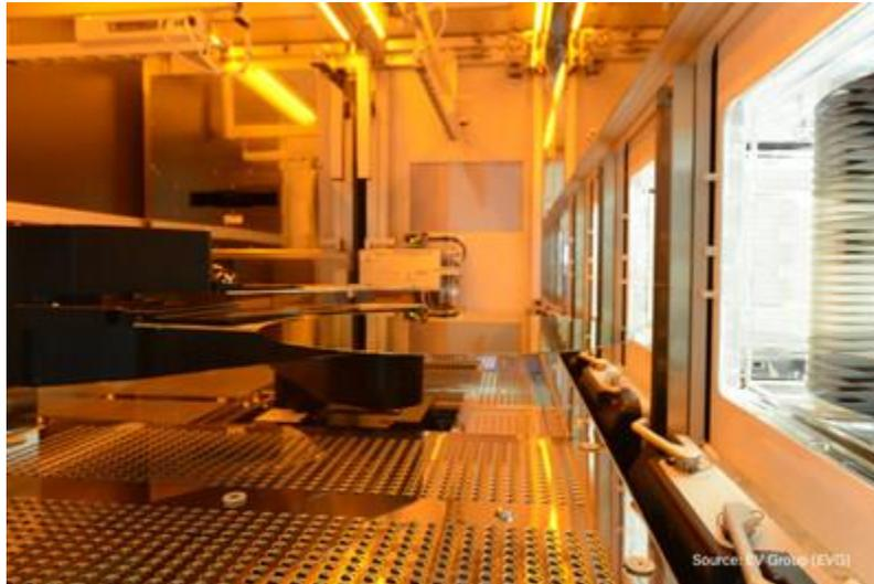
EVG®850 NanoCleave™ レイヤー剥離装置の内部。前処理用モジュールベイと後方にはメカニカル剥離モジュール。提供: EV Group
