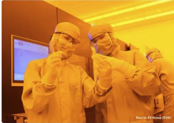
在EV Group 的NIL Photonics R能力中心，工藝工程師正在檢查200mm晶圓，晶圓上的超構透鏡是用Toppan Photomask生產的母版和EVG的奈米壓印光刻(NIL)工藝複製而成。來源：EV Group。
