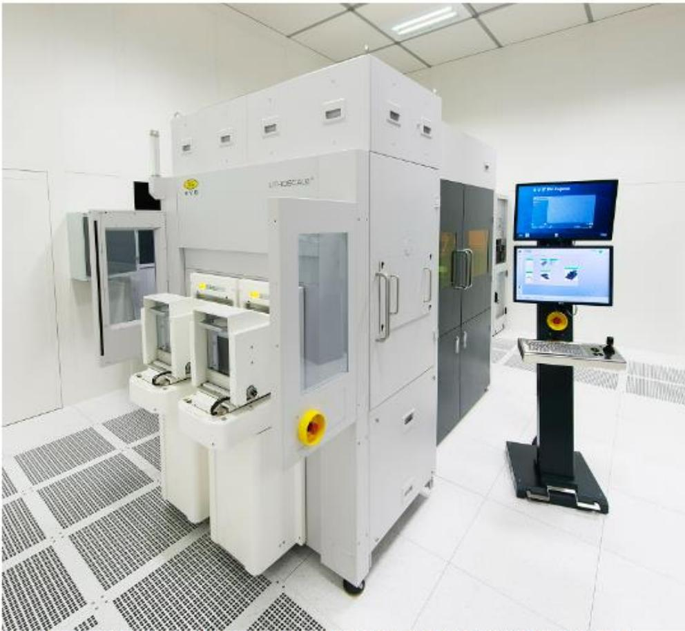
EVG는 Hi-CHIP 협력체의 회원사로서 LITHOSCALE® 마스크리스 노광 리소그래피 설비, EVG®850 DB 자동 디본딩 설비, GEMINI®FB 하이브리드 본딩 설비 같은 첨단 웨이퍼 본딩 및 리소그래피 설비를 제공한다. ITRI의 최신 연구 시설에 이 같은 대량 생산 설비들이 설치됨에 따라 앞으로 EVG와 ITRI의 공동 고객들은 새로운 이종 접적 프로세스를 빠르게 개발하고 R&D에서 고객의 펌으로 신속히 이전할 수 있게 되었다.
