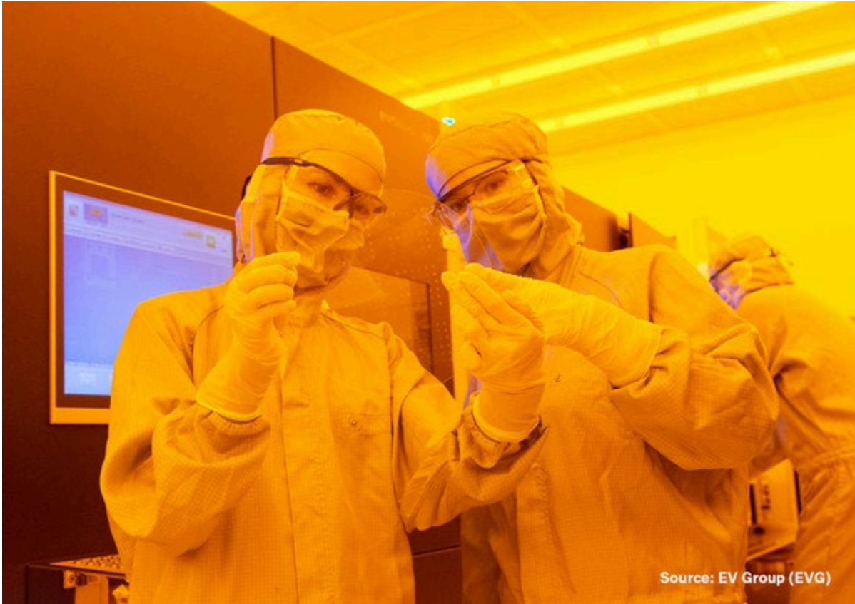
EV Group의 NILPhotonics(R) Competence Center의 공정 엔지니어들이 Toppan Photomask에서 제조한 마스터와 EVG의 나노임프린트 리소그래피(NIL) 공정으로 복제된 메타렌즈(Metalenses)를 갖춘 200-mm 웨이퍼를 검사하는 모습. 사진 제공: EV Group
