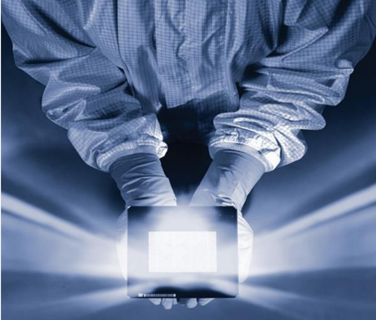
Toppan Photomask制造的半导体用光掩模，纳米压印光刻(NIL)母版采用同样的材料、技术和工艺制造而成。来源：Toppan Photomask。
