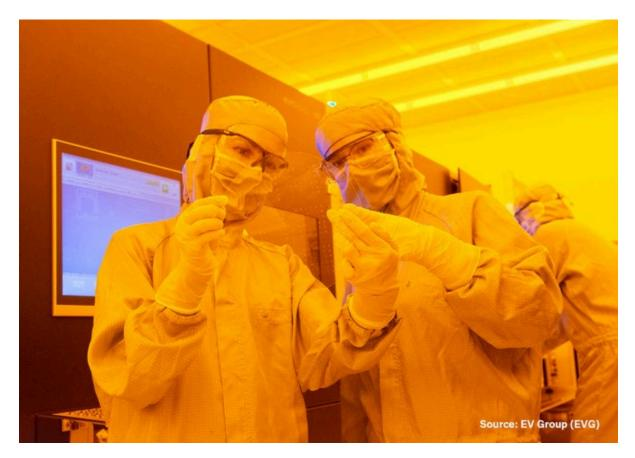
在EV Group 的NILPhotonics®能力中心,工艺工程师正在检查200mm晶圆,该晶圆上的超构透镜是用Toppan Photomask生产的母版及EVG的纳米压印光刻(NIL)工艺复制而成。来源: EV Group。作为此次非排他性合作的一部分,EVG和Toppan Photomask将结合各自的知识、专长和服务,利用Toppan Photomask提供的主模板和EVG提供的设备及工艺开发服务,提供NIL开发工具包,以进一步推广NIL技术并提高将该技术应用于工业生产的可能性。EVG还将在其位于奥地利总部的EVGNILPhotonics®能力中心,面向感兴趣的公司提供NIL技术和产品演示。此外,对于有意在生产过程中使用NIL技术的企业,两家公司都将对方指定为首选推荐的供应链合作伙伴。
