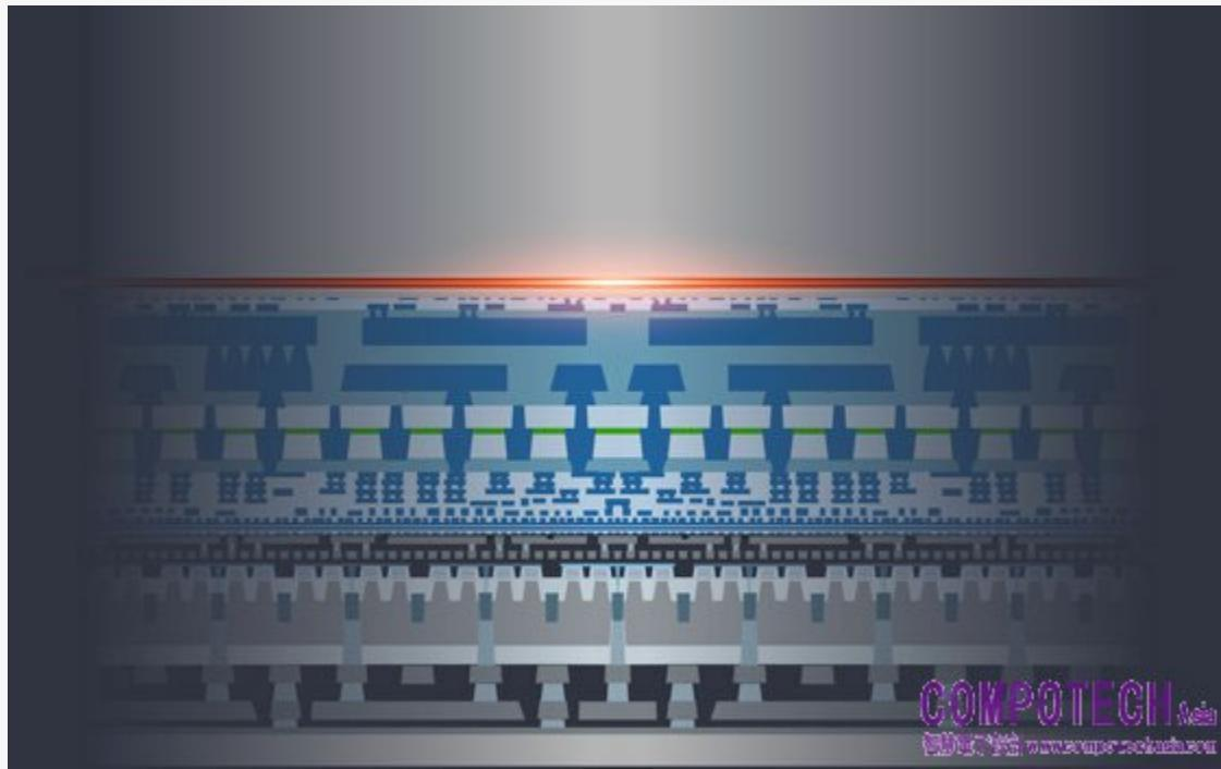
NanoCleave是一種完全與前段相容的薄膜釋放技術，特色是使用紅外線（IR）雷射，可穿透對IR雷射波長呈透明狀態的矽晶圓。該項技術搭配使用特殊配方的無機層，能在奈米級精度下利用IR雷射，從矽載具釋放任何超薄的薄膜。
