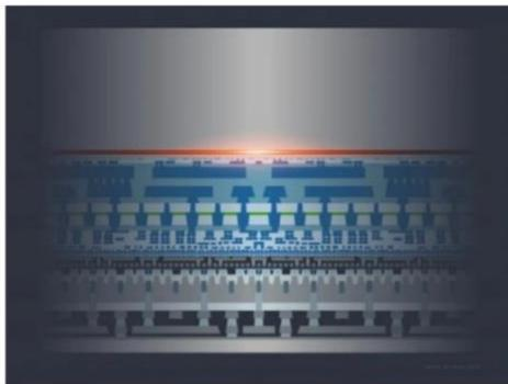
EV集团革命性的硅离型层技术NanoCleave波长可穿透硅层的红外激光和无机层材料，可以释放硅载体上的任何超薄膜或超薄层，精度可达到纳米级别 (EV集团供图)
