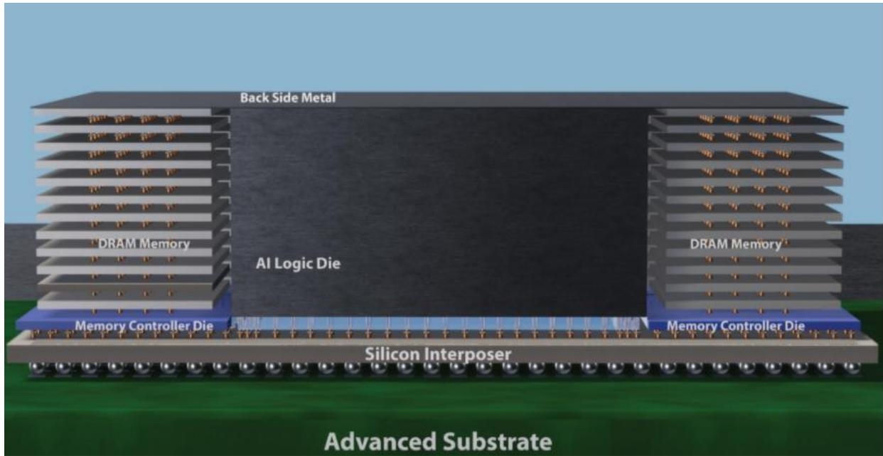
异构集成通过将具备不同技术、功能和尺寸的芯片集成到单一封装内，为半导体和设备公司的设计和制造赋予了全新的灵活性。应用材料公司结合在工艺和大面积衬底方面的领导地位，携手生态系统加速行业的异构设计和集成路线图。
