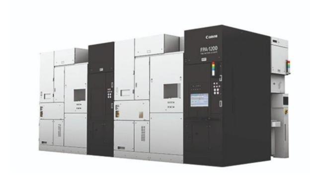
Ohne Linsen und Licht- bzw. EUV-Quelle kommt das neue Nanomimprint-Lithografiegerät »FPA-1200NZ2C« von Canon aus, mit dem sich 5-nm-ICs fertigen lassen. Das könnte den Fertigungsprozess für ICs deutlich kostengünstiger als bisher machen.
