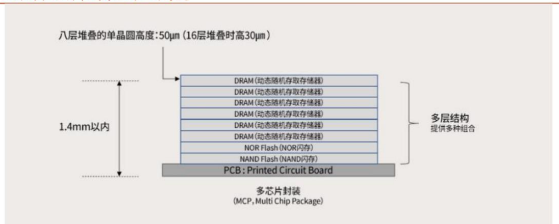
图 57: 多芯片封装结构中减薄后的芯片厚度
