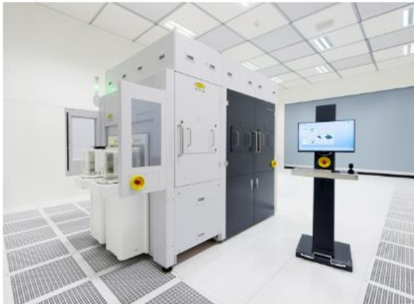
▲EVG®40 NT2 자동 계측 시스템은 마스크리스 리소그래피 애플리케이션뿐만 아니라 웨이퍼 투 웨이퍼, 다이 투 다이 본딩에 대한 오버레이 및 CD 측정 기능을 제공한다.
