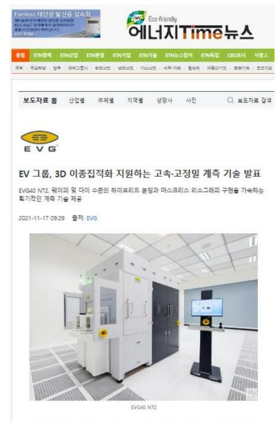
서울--(뉴스와이어) 2021년 11월 17일 -- MEMS, 나노 기술, 반도체 제조용 웨이퍼 본딩 및 리소그 래피 장비의 선도적 공급사인 EV 그룹(이하 EVG)이 EVG®40 NT2 자동 계측 시스템을 발표했다. 이 시스템은 웨이퍼-투-웨이퍼(W2W), 다이 투-웨이퍼(D2W), 다이-투-다이(D2D) 본딩 애플리케이 선과 마스크리스 리소그래피 애플리케이션에서 오버레이 및 임계 선폭(critical dimension, CD)을 측정하는 기술이다. 실시간 공정 수정 및 최적화를 위해 피드백 루프를 사용하는 대량 생산을 지원 하도록 설계된 EVG40 NT2를 활용함으로써 디바이스 제조사, 파운드리, 패키징 하우스는 새로운 3D/이종집적화(heterogeneous integration) 제품 도입을 앞당기고, 수율을 향상하며, 고부가 가치 의 웨이퍼 폐기량을 크게 즐일 수 있다.
