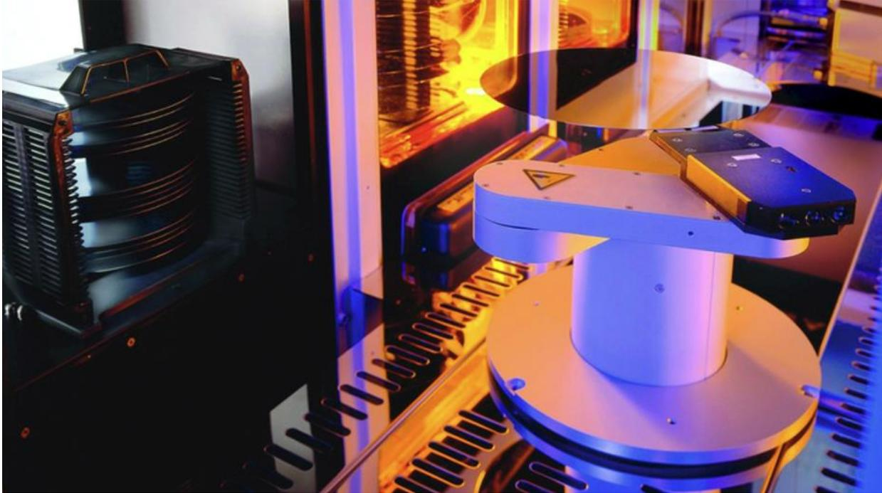
Wafer-Bonder von Süss Microtec
