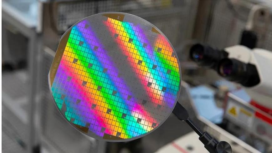
与硅基半导体相比，SiC优势更加突出，例如后者拥有更好的导电性、更高的开关频率及更低的能耗。采用SiC芯片的电力电子设备可以在更高的温度下工作，从而节省了高昂的冷却成本。另外，SiC的击穿电场强度是硅的10倍，这意味着功率组件尺寸可以更小，同时提供更高的转换效率。
